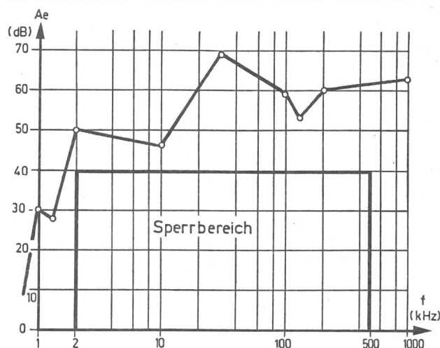
Fig. 3 Einfügungsdämpfung A_e in Abhängigkeit von der Frequenz f Filter 380 V~/130 A, gemessene Werte
