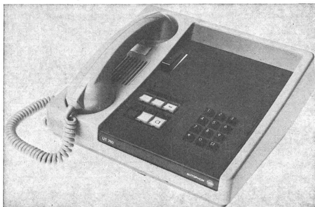
Fig. 2 Universaltelefon mit eingebautem Mikroprozessor
