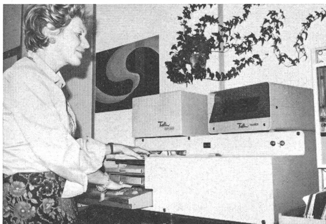
Fig. 3 Einlesen der Ablesbelege mit dem optischen Lesesystem Feller-OCR 2002
