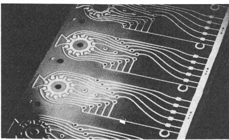
Wesentliche Forderung in diesem System ist Verschleissfestigkeit, die ein konstantes Kontaktverhalten gewährleistet. Diese Forderung erfüllt unsere hochwertige korrosionsbeständige 18-kt-AuCuCd-Legierungsvergoldung GALVATRONIC; sie hat sich seit vielen Jahren in der Elektronik und Elektrotechnik hervorragend bewährt. Die GALVATRONIC-Hartvergoldung zeichnet sich aber auch dank des niederen Goldgehaltes und des geringen spezifischen Gewichtes durch hohe Wirtschaftlichkeit aus.
