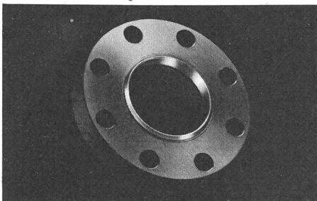
Reinstgold ist ein idealer Werkstoff für den Einsatz in metallgedichteten Apparaturen. Die 50 µm dicke Goldschicht wird nur an der funktionellen Stelle (im Bild als heller Streifen erkennbar) aufgebracht. Die spezielle Werkstoffpaarung – der Ventilteller besteht aus Saphir, der Ventilsitz wird durch die reinstvergoldete Edelstahlkante gebildet – gestattet, Ventile dieser Art auch bei erhöhten Temperaturen für korrosive Gase einzusetzen und erlaubt eine Ausheizbarkeit bis zu 450°C.
