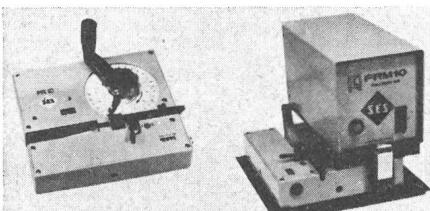
brücken: PR 10 Ablängen einstellbar bis 25 cm; PR 10E mit Elektronikzusatz zum Ablängen bis 250 cm; PR 20 zur Herstellung (schneiden und biegen) von Drahtbrücken, Draht-Ø Standardausführung für 0,7 mm, Schenkellänge verstellbar von 3 bis 8,5 mm, Brückenlänge verstellbar von 4 bis 125 mm. Bei jeder vollen Umdrehung der Kurbel wird ein fertiges Teil produziert; Drehgeschwindigkeit bis zu 90 U/min.
