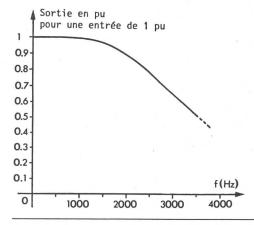
Fig. 4 Courbe de réponse en fréquence de la transmission complète
