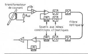
Fig. 2 Bloc diagramme d'un transformateur de courant à capteur actif et transmission par modulation de fréquence à l'aide de fibres optiques  $U_{\rm p} \ \ {\rm tension} \ \ {\rm de \ polarisation}$
