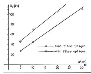
Fig. 5 Rigidité dielectrique  $U_d$  d'un espace d'air à 50 Hz, sans et avec fibre optique
