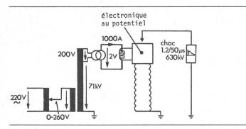
Fig. 6 Schéma de l'essai synthétique du transformateur de courant au potentiel
