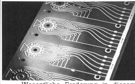
Wesentliche Forderung in diesem System ist Verschleissfestigkeit, die ein konstantes Kontaktverhalten gewährleistet. Diese Forderung erfüllt unsere hochwertige korrosionsbeständige 18-kt-AuCuCd-Legierungsvergoldung GALVATRONIC; sie hat sich seit vielen Jahren in der Elektronik und Elektrotechnik hervorragend bewährt. Die GALVATRONIC-Hartvergoldung zeichnet sich aber auch dank des niederen Goldgehaltes und des geringen spezifischen Gewichtes durch hohe Wirtschaftlichkeit aus.
