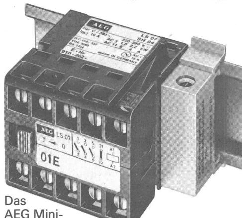
Das AEG Mini-schütz LS 07 hat ein Format, das genau unter die Blindabdeckung im Verteilerkasten passt. Im AC 1-Betrieb schaltet es 16 A und im AC 3-Betrieb 2,2 kW bei 380 V~. Das LS 07 gibt es mit Schraub-, Flachsteck- und Stiftanschlüssen, mit Gleich- und Wechselstromspule – und serienmäßig mit Schraub- und Schnappbefestigung.
