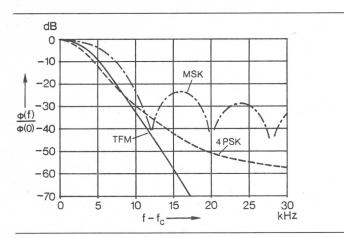
Fig. 3 Normiertes Leistungsdichtespektrum für gefilterte 4-PSK, MSK und TFM
