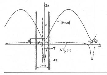
Fig. 2 Kanaleinbruch durch selektives Fading b = 0.8;  $\tau B = 0.25$
