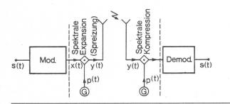
Fig. 4 Allgemeines Blockschema eines Spread-Spectrum-Übertragungssystems
