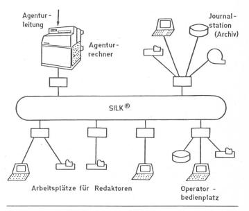
Fig. 2 Nachrichtenverteilung in einer Rundfunkanstalt
