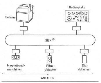
Fig. 3 Steuerungsaufgabe im Fernsehstudio
