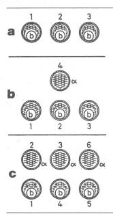
Fig. 1 Querschnitte integralgekühlter Kabelanlagen mit den integralgekühlten Kabeln b und den lateralen Kühlrohren  $\alpha$
