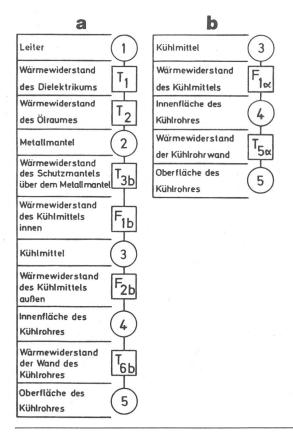
Fig. 2 Wärmewiderstände pro Länge sowie Nummern von Aufbauelementen und Flächen
