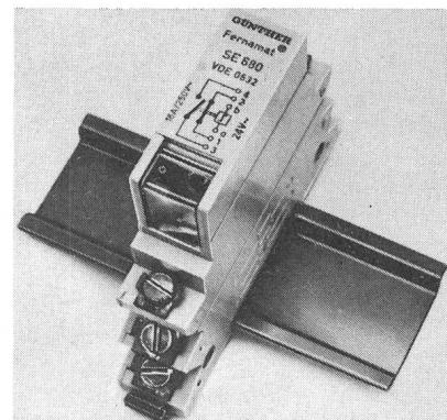
schalter sowie Gruppenschalter. Die Installationsrelais gibt es mit einem Schliesser, zwei Schliessern, einem Öffner, zwei Öffnern sowie mit einem Schliesser und einem Öffner. Wahlweise stehen die Spulen Spannungen 8, 12, 24, 48 und 220 V~ zur Verfügung.
