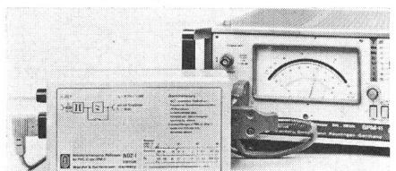
handenen Pegelmessgeräten SPM-11 oder PMG-13 sind Messungen der Oberschwingungen  $n_1, n_2 \dots$  bis  $n_{40}$  möglich. Durch einen eingebauten Hochpass kann die 50-Hz-Grundwelle unterdrückt werden. Über eine am NOZ-1 aufgedruckte Tabelle kann das Messergebnis leicht von dB in %-Werte umgerechnet werden. In verschiedenen Ausbaustufen kann der Oberschwingungsmessplatz mit einem  $y-t$ -Schreiber zur Registrierung ausgerüstet oder sogar zum automatischen Meßsystem ausgebaut werden.
