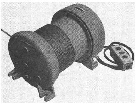
trieb wird an die Winde angebaut und kann wahlweise aus einem Elektro-, Benzin- oder Dieselmotor bestehen;
