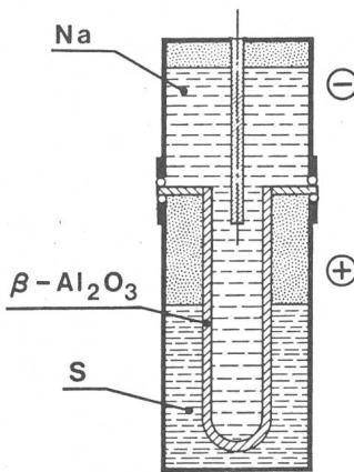
Fig. 1 Schematischer Aufbau einer Einzelzelle einer Natrium-Schwefel-Batterie
