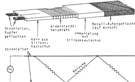
z.B. Bohrinseln oder weitab gelegene Projekte. Das Heizband kann an Rohrleitungen mit Temperaturen zwischen -50 und +160 °C eingesetzt werden; es widersteht Temperaturen bis 180 °C. Geeignet für Wechselspannung 220 und 240 V, ist er sowohl für Innen- als auch für Ausseneinsatz verwendbar und auch resistent gegen bestimmte korrosive Einflüsse. Es wird mit spezifischen Heizleistungen von 8,5 und wahlweise 12,5 sowie 25 W/m Heizbandlänge gefertigt.
