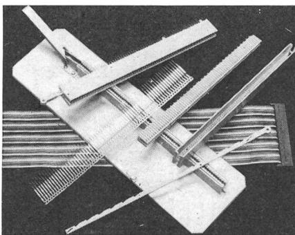
Über einen Bedienhebel lassen sich die Kontaktfedern öffnen (zum Einschieben der Steckkarte) bzw. schliessen (zur Kontaktgebung).
