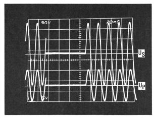
Fig. 13 Dynamisches Verhalten des Messverstärkers bei Primärkurzschluss der Eingangsspannung
