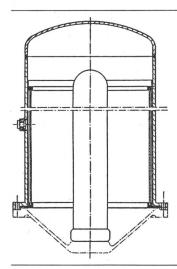
Fig. 7 Kapazitiver Teiler, bei welchem sich Ober- und Unterspannungskondensator im SF<sub>6</sub>-Raum befinden
