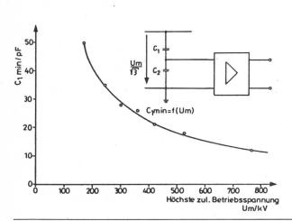
Fig. 6 Richtwerte der minimalen Kapazität des Hochspannungskondensators  $C_1$
