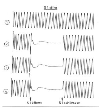
Fig. 17 Spannungsverläufe verschiedener Messeinrichtungen und Übertragungssysteme beim Schalten auf der 245-kV-Seite
