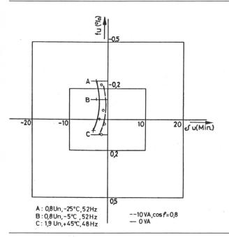
Fig. 11 Fehlerdiagramm der Extremwerte bei Spannungsänderung 0,8 bis 1,9  $\times$   $U_{\rm n}$ , Frequenzänderung 48 Hz bis 52 Hz und Temperaturänderung -25  $^{\circ}{\rm C}$  bis +45  $^{\circ}{\rm C}$
