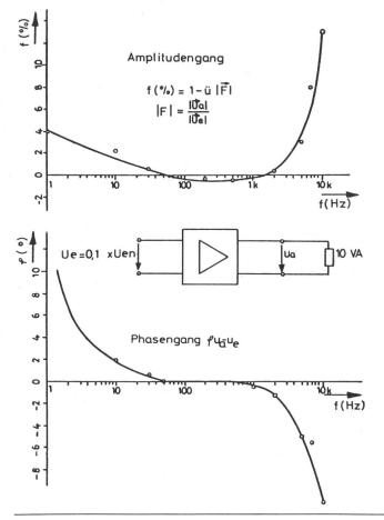
Fig. 12 Frequenzgang eines Messverstärker-Schutzganges
