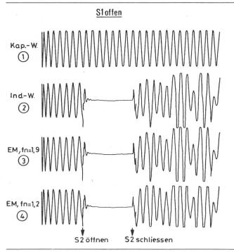
Fig. 16 Spannungsverläufe verschiedener Messeinrichtungen und Übertragungssysteme bei Schalten auf der 123-kV-Seite
