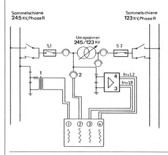
Fig. 15 Anordnung für Schaltversuche in einem 245/123-kV-Schaltfeld
