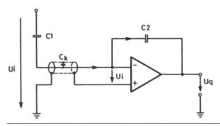
Fig. 2 Grundschaltung nach dem Prinzip der Strommessung
