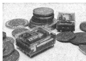
mit 8 µm Goldauflage) erbringen eine Schaltleistung von max. 60 W/60 VA bei einer Schaltspannung von max. 125 V<sub>AC</sub> und einem Schaltstrom von max. 2 A<sub>AC</sub>. Die Ansprechleistung liegt bei 310 mW. Die Anschlussstifte passen in das übliche 2,54-mm-Raster. Das Relais wird mit allen üblichen Betriebsspannungen 6...48 V geliefert.
