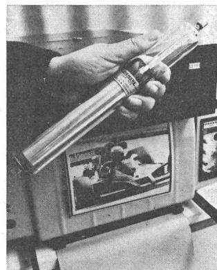
Siemens gelungen, die bisher recht beschränkte Modulationsfähigkeit von Laserröhren auf 100 % zu steigern. Der neue HeNe-Typ LGR 7625 mit einer Ausgangsleistung von 0,4 mW ist 298 mm lang; der Durchmesser beträgt 36 mm. Eingesetzt wird die Röhre erstmals im neuen Telebild-Empfänger TM 4006 der Firma Hell in Kiel. Der Laser zeichnet automatisch auf Dry-Silver-Papier, das von einer Rolle abläuft. Ein thermisch arbeitender Entwicklungsautomat liefert anschliessend das fertige Bild.
