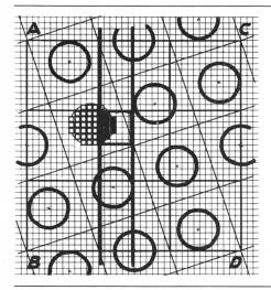
Fig. 4 Aufzeichnung der elektronisch erzeugten Rasterpunkte: Rasterwinkel 18.4°
