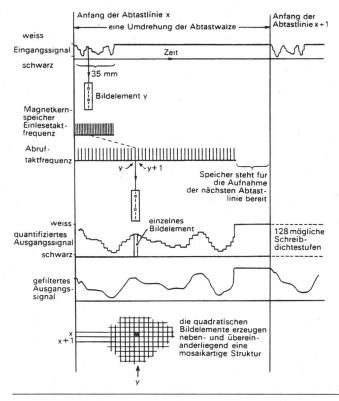
Fig. 5 Elektronische Bilddatenvergrösserung in vertikaler Richtung
