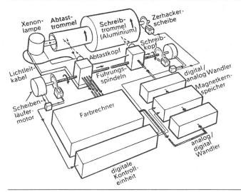
Fig. 2 Schematische Funktionsweise eines Scanners
