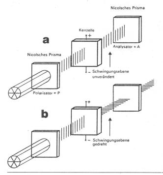
Fig. 3 Modulierung des Lichtstrahles mittels Kerrzelle
