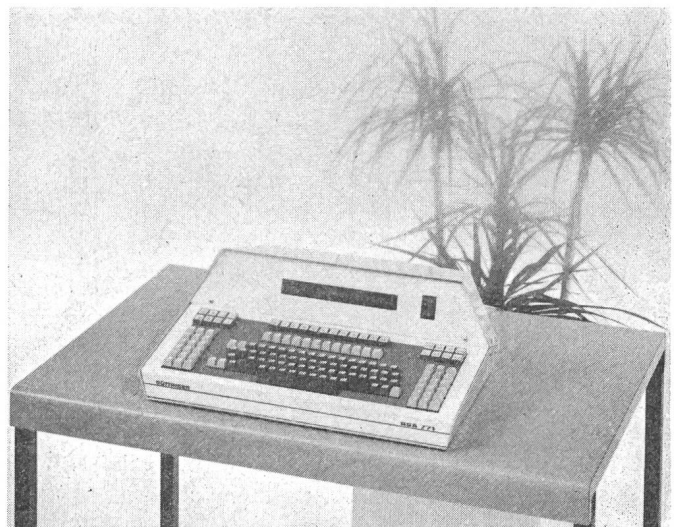
Fig. 3 Beispiel eines Erfassungsgerätes GSA 771-Endlostaster mit Display zur Selbstkontrolle und zur textlichen Korrektur. Die letzten 40 Zeichen und Funktionen sind jeweils sichtbar
