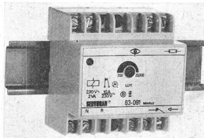
pensiert und verfügt über eine eingebaute Zeitverzögerung gegen kurzzeitige Licht-einflüsse. Das regelbare Schaltgerät ist ge-normt und kann für AP- und DIN-Schienen-Montage verwendet werden. Der Typ 30-090 ist als Dämmerungsschalter, der Typ 30-091 für Beleuchtungs- und Storensteuerung vorgesehen.
