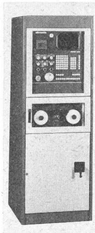
Bahnkorrekturen, auch für Innenkonturen; Unterprogrammtechnik mit Parameterüber-gabe; freiprogrammierbare Anpaßsteuerung. Die Steuerung wird sowohl als 19"-Einschub als auch als Standard-Kompaktversion ge-liefert. Letztere enthält, eingebaut in einen Schrank, neben der Steuerung auch die Vor-schub- und Spindelantriebe, die freiprogrammierbare Anpaßsteuerung mit Starkstromteil sowie die Datenperipheriegeräte.
