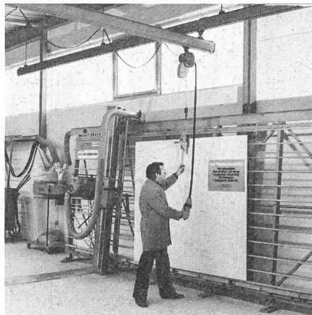
bearbeitungsmaschinen stehen die gängigen Sägen, Hobel-, Schleif- und Spezialmaschinen für die Vorführung bereit. Früher benötigte der Verkäufer eine Hilfskraft, wenn er beispielsweise die Arbeitsweise einer neuen Plattsäge zeigen wollte. Die jeweilige Platte musste von Hand aus dem Lagerständer gezogen und zur Säge gebracht werden. Heute schafft der Vorführer die Arbeit allein mit einem KBK-Hängekran von DEMAG.
