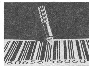
Lichtwellenlänge von 700 nm auf die abtastende Fläche. Die andere, identische Hälfte der Linse fokussiert das reflektierte Licht auf einen integrierten Silizium-Photo-Detektor. Ein im Detektor enthalterner Transistor bietet zusätzliche Verstärkung. Die Öffnungszahl von 0,3 ermöglicht maximale Lichtausbeute. Sphärische Aberration wird durch die Verwendung asphärischer Linsenoberflächen vermeiden.
