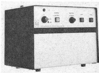
geladen und gibt, wenn nicht laufend gespiesen, während einer Stunde eine Leistung von 40 W mit einer Rechteckspannung 50 Hz bei 220 oder 110 V ab. Es enthält einen gasdichten Bleiakkumulator und kann, dank robuster Bauart, geringem Gewicht (7,5 kg) und praktischem Traggriff überall, wo Strom benötigt wird, eingesetzt werden. Die Einheit schützt sich selbst gegen Kurzschluss, Tiefentladung und Fehlbedienung.
