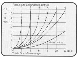
◆Druckverlust m WS bei Ersatz von 6 alten parallelen Leitungen durch eine einzige, neue Leitung.
