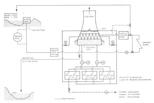
Fig. 1 Abwärme-Entnahme aus dem Kernkraftwerk Gösgen
