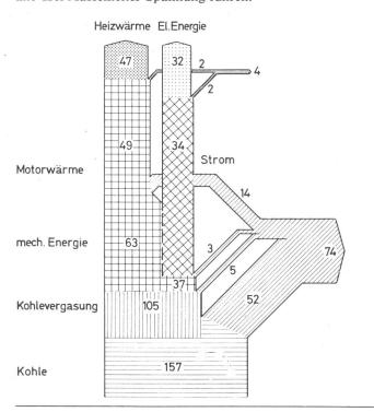
Fig. 1 Wärme- und Stromerzeugung im Blockheizkraftwerk über Kohlevergasung
