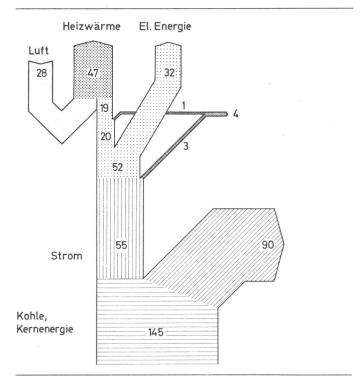
Fig. 2 Wärme- und Stromerzeugung mit Wärmepumpe und Kraftwerk
