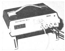
Il dispose en outre de deux sondes de température à résistance variable dont l'étalonnage est indépendant de la longueur des connexions. L'appareil indique la valeur des températures ou la différence entre celles-ci. Le coefficient de transmission d'un mur, par exemple, s'obtient très simplement. Pour assurer un contrôle pendant une longue durée, des sorties sont prévues pour commander un enregistreur analogique ou une imprimante digitale.
