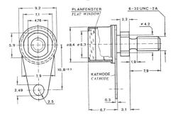
Übergang vom Bauelement zur Übertragungsstrecke. Der Übertragungsfrequenzbereich reicht von 1 MHz bis über 1 GHz.
