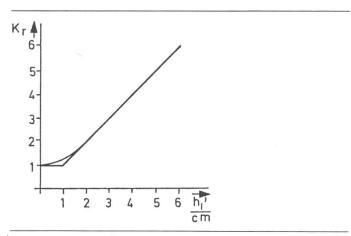
Fig. 1 Widerstandsfaktor der Stromverdrängung  $K_r = f(h_1')$  $h_1'$  reduzierte Leiterhöhe [3]
