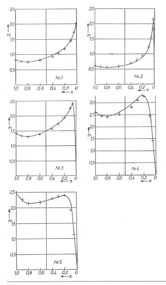
Fig. 3 Vergleich der gemessenen Drehmomentkennlinien mit der Rechnung
