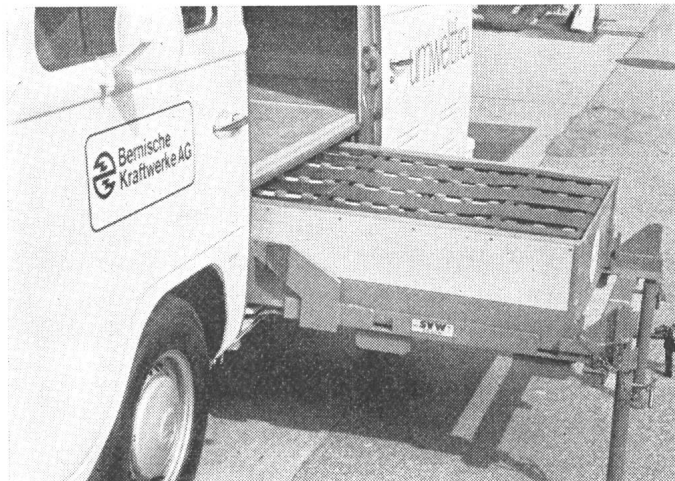
Fig. 2 Batterieeinschubeinheit des VW-Transporters der BKW
