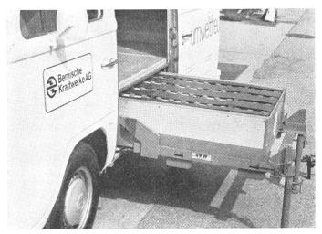
Fig. 2 Batterieeinschubeinheit des VW-Transporters der BKW
