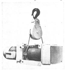
Produkte anzubieten. Die einzelnen Elemente der kleinen Elektroseilzüge, wie polumschaltbarer Hubmotor, Hubwerksgetriebe, Seiltrommel mit Seilführung, elektromecha-
