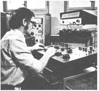
Fig. 6 Präzisions-Widerstandsmessbrücke mit Lichtmarkengalvanometer Im Hintergrund die Gleichstromeichquelle 10 µA...15 A
