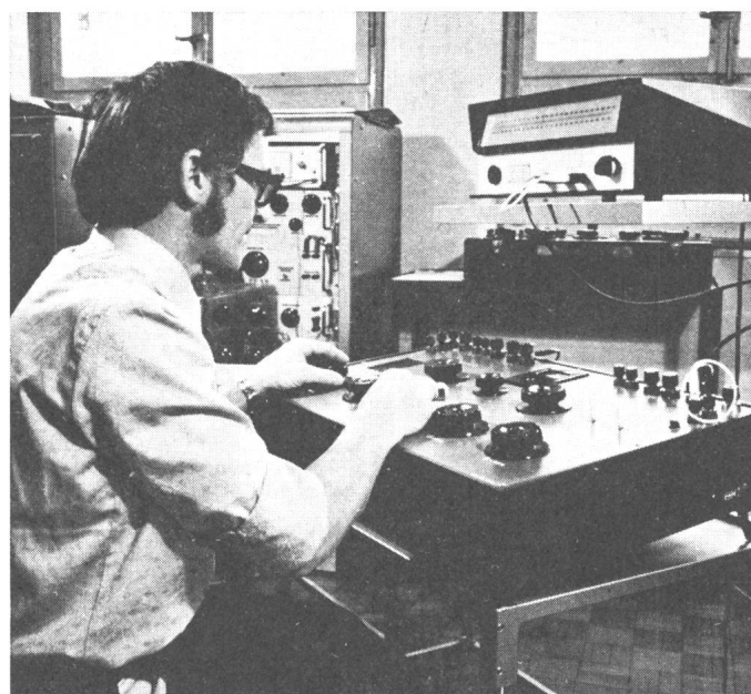
Fig. 6 Präzisions-Widerstandsmessbrücke mit Lichtmarkengalvanometer Im Hintergrund die Gleichstrom-eichquelle 10 \mu A...15 A
