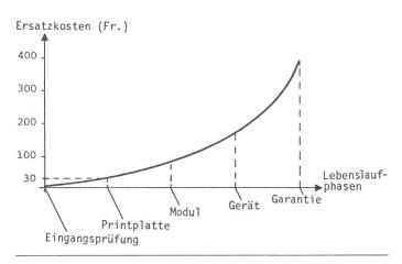
Fig. 2 Typischer Verlauf der Kosten für den Ersatz einer defekten integrierten Schaltung (SSI bis MSI)
