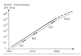
Fig. 1 Komplexitätszunahme der integrierten Schaltungen SSI, MSI, LSI, VSLI: small, medium, large, very large scale integration
