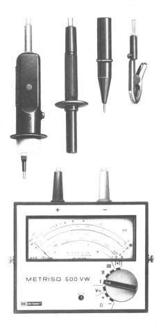
Modernes, batteriebetriebenes Isolationsmessgerät für Anlagen und Geräte mit Nennspannungen 500 V~ oder 750 V=.
