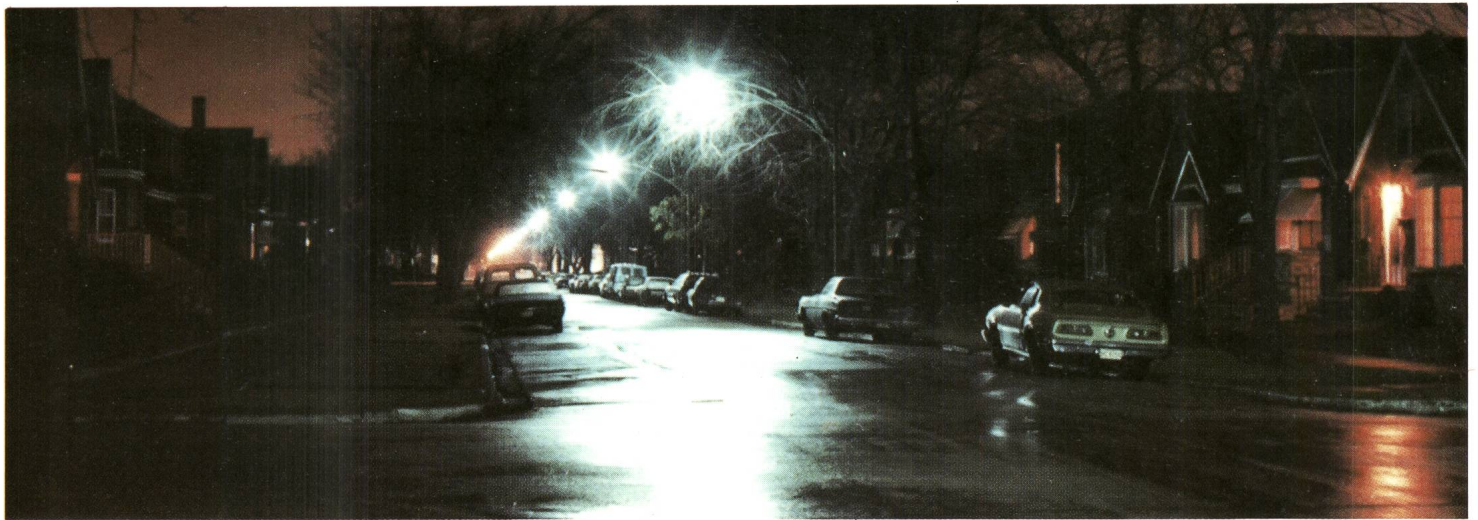
Wohnstraßenbeleuchtung mit herkömmlichen Quecksilberdampflampen.
