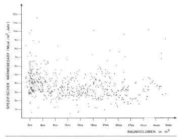
Fig. 1 Wärmeverbrauch aus Öleinsatz
