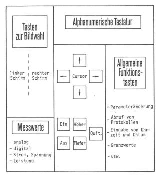
Fig. 3 Grundsätzlicher Aufbau der Steuerkonsole
