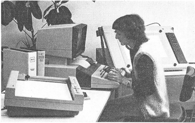
Tischcomputer HP-9845 mit Digitalisierer (Hintergrund) und 4-Farben-Plotter
