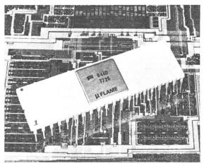
16-Bit-Mikroprocessor CPU in I<sup>3</sup>L-Technologie (Fairchild 9440)
