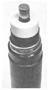
In der Reihe der EPR-isolierten Hochspannungskabel wurden die für die Spannungsebenen von 10...132 kV vorhandenen Kabel bis auf 150 kV weiterentwickelt. Diese Kabel können je nach Bedürfnis (Anwendung, Montage oder Verlegebedingungen) mit verschiedenen Metallmänteln wie z.B. Blei oder Wellmäntel ausgerüstet werden. Damit ist Cossonay an der Spitze der Hersteller auf dem Weltmarkt von 150-kV-Kabeln mit Kunststoffisolation.
