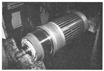
Rotor für Traktionsmotor
