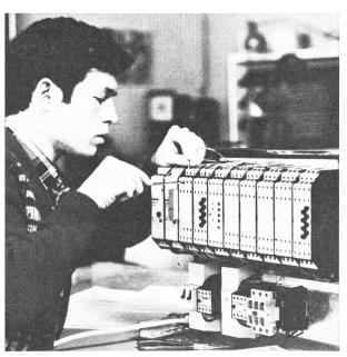
Speicherprogrammierbares Automatisierungsgerät SIMATIC S5 für starkstromnahen Einsatz
