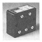
Einschaltstrombegrenzer für induktive Bauelemente Völlig neu ist der *Einschaltstrombegrenzer* der Ismet-Werke, Schwenningen. Er begrenzt die Stromspitzen beim Einschalten induktiver Bauelemente wie zum Beispiel Transformatoren, Motoren usw. Das kleine Vorschaltgerät ermöglicht den Einsatz von schnell schaltenden Sicherungsautomaten und damit eine selektive Absicherung insbesondere im Schaltanlagenbau.
