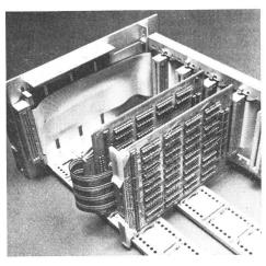
Breadbord-System für Prototypenleiterplatten
