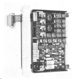
Parallelschalt-Automat; Gehäuse geöffnet
