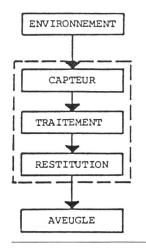
Fig. 1 Schéma bloc d'un système d'aide aux aveugles
