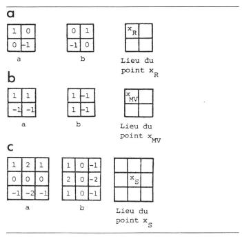
Fig. 4 Fenêtres de filtrage passe-haut, et localisation dans la fenêtre du résultat du filtrage pour les opérateurs de Roberts (a), Mero-Vassy (b) et Sobel (c)
