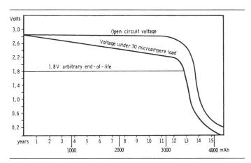
Fig. 3 Entladecharakteristik der Lithiumjodid-Batterie
