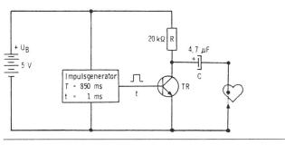
Fig. 4 Funktionsprinzip eines festfrequenten Schrittmachers
