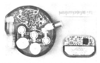
Grössenvergleich (cm-Skala) eines Bedarfsschrittmachers mit diskreter Schaltung mit einem modernen Schrittmacher in Hybridschaltung sowie mit einer Lithiumjodid-Batterie
