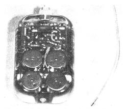
Bedarfsschrittmacher mit Quecksilberbatterien und diskreter Elekronik Elektronik und Batterie sind im Epoxydharz vergossen, welches das Gehäuse des Schrittmachers bildet
