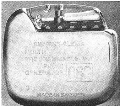
Fig. 9 Moderner multiprogrammierbarer Schrittmacher Dieser Schrittmacher kann für 41 Parameter-Kombinationen programmiert werden, um eine für den einzelnen Patienten optimale Funktion zu erzielen
