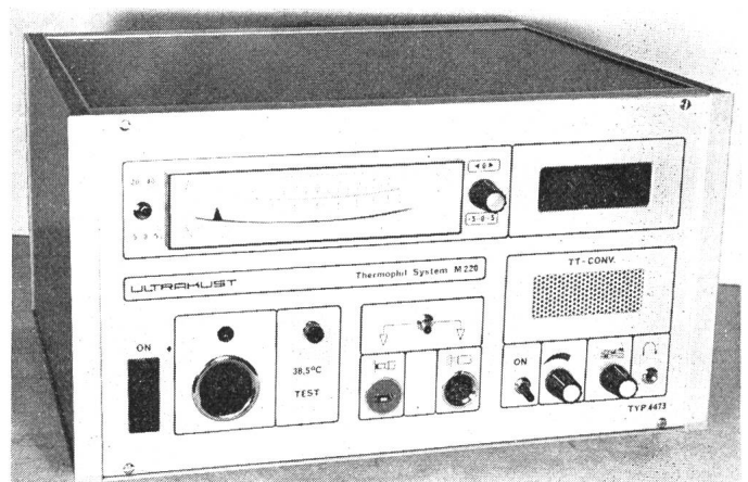
Fig. 3 Ansicht eines IR-Messgerätes mit wahlweisem Anschluss einer Kontaktsonde oder einer berührungslosen Sonde
