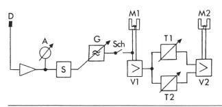
Fig. 5 Prinzipschaltung eines kombinierten Tiefenreizstromund MORA-Therapiegerätes mit Thermographieüberwachung
