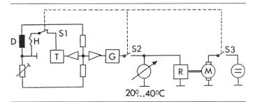
Fig. 1 Prinzipschaltbild eines Thermographiegerätes mit Kontaktsonde
