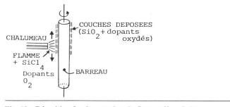
Fig. 10 Déposition des dopants dans la flamme d'un chalumeau
