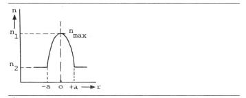
Fig. 5 Indice de réfraction d'une fibre à gradient
