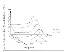
Fig. 8 Gemessener Verlauf der relativen Intensitäts-Rauschdichte im 1/f-Bereich
