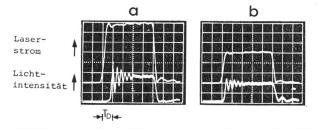
Fig. 3 Einfluss der Diodenvorspannung auf die Einschalt-Verzögerungszeit und die Relaxationsoszillationen des Laserlichts beim Channeled-Substrate-Laser<sub>si</sub>
