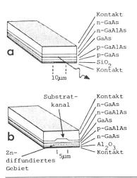
Fig. 1 Strukturen der untersuchten GaAlAs-Doppelheterostruktur-Diodenlaser
