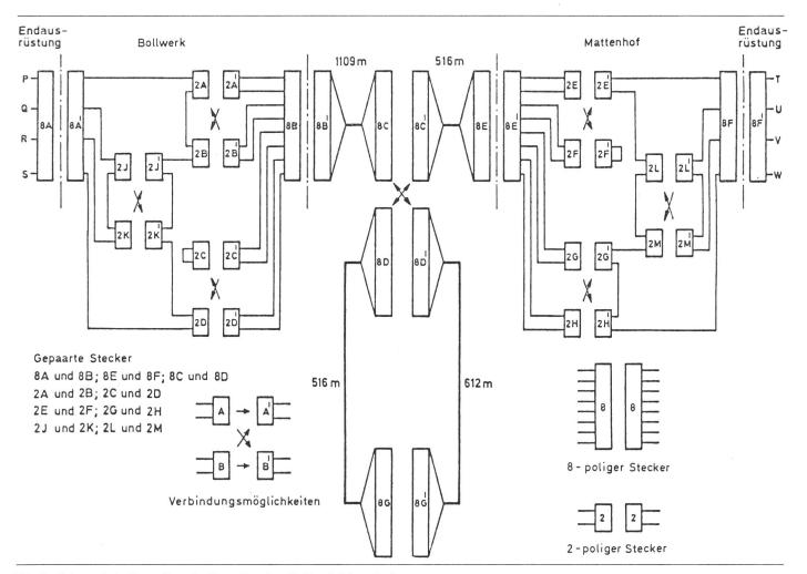
Fig. 2 Schematische Darstellung der Versuchsanlage Bollwerk-Mattenhof
