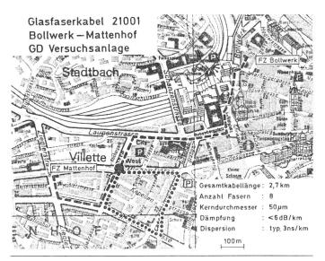
Fig. 1 Topologischer Plan der Anlage
