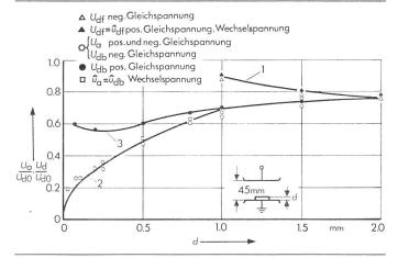
Fig. 8 Abhebespannungen  $U_{\rm a}$  und Durchschlagspannungen  $U_{\rm d}$  bei Anwesenheit eines zylinderförmigen Kupferteilchens der Länge l=10 mm im homogenen Feld in Abhängigkeit vom Teilchendurchmesser d
