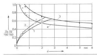
Fig. 7 Abhebespannungen  $U_{\rm a}$  und Durchschlagspannungen  $U_{\rm d}$  bei Anwesenheit eines kugelförmigen Metallteilchens im homogenen Feld bei unterschiedlicher Teilchendichte  $\varrho$  in Abhängigkeit vom Teilchendurchmesser d
