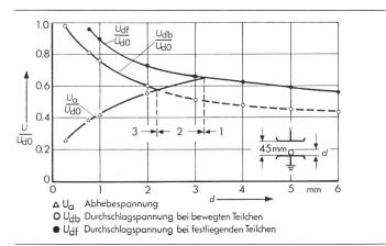
Fig. 2 Abhebespannung und Durchschlagspannung in Abhängigkeit vom Durchmesser d einer Cr/Ni-Stahlkugel im Gleichfeld
