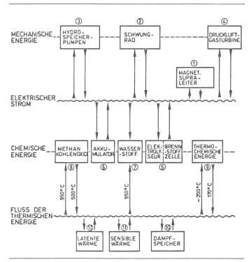
Fig. 3 Umwandlung der sekundären Energie für Speicherung und Übertragung
