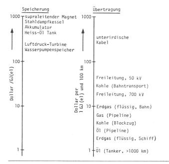
Fig. 5 Kosten der Speicherung bzw. der Übertragung auf 100 km Distanz von 1 GJ (el)
