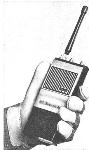
verbindungen auch auf grössere Distanzen möglich und sicherer. Das kleine Gerät mit einem Ganzmetallgehäuse ist gut geschützt gegen Nässe und Staub und findet deshalb einen breiten Einsatz bei Rettungsorganisationen, Feuerwehren, Polizei und Industriebetrieben, also überall wo es auf sichere und ungestörte Verbindungen ankommt.
