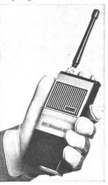
verbindungen auch auf grössere Distanzen möglich und sicherer. Das kleine Gerät mit einem Ganzmetallgehäuse ist gut geschützt gegen Nässe und Staub und findet deshalb einen breiten Einsatz bei Rettungsorganisationen, Feuerwehren, Polizei und Industriebetrieben, also überall wo es auf sichere und ungestörte Verbindungen ankommt.
