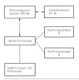
Fig. 3 Blockdiagramm des Mikrocomputer-gesteuerten Strom-Zeit-Messplatzes
