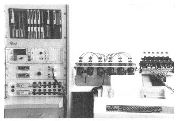
Fig. 2 Gesamtsicht des Strom-Zeit-Messplatzes
