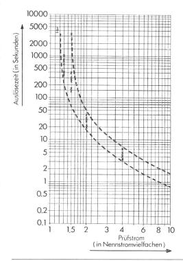
Fig. 1 Schaltkennlinie mit Streubereich Geräteschutzschalter T 12 Nennstrom 12 A
