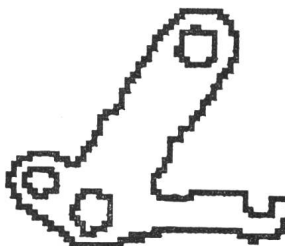
Fig. 9 Contour d'une pièce observée par une caméra de télévision (cf. fig. 1)
