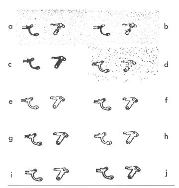
Fig. 6 Traitement pour l'extraction des contours d'images de pièces mécaniques
