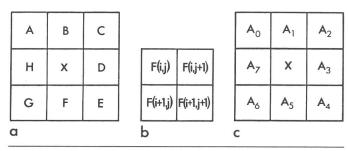
Fig. 3 Position des points de l'image à l'intérieur des fenêtres de traitement par les opérateurs locaux
