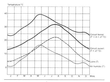
Fig. 4 Températures des eaux de refroidissement à Saint-Laurent-des-Eaux
