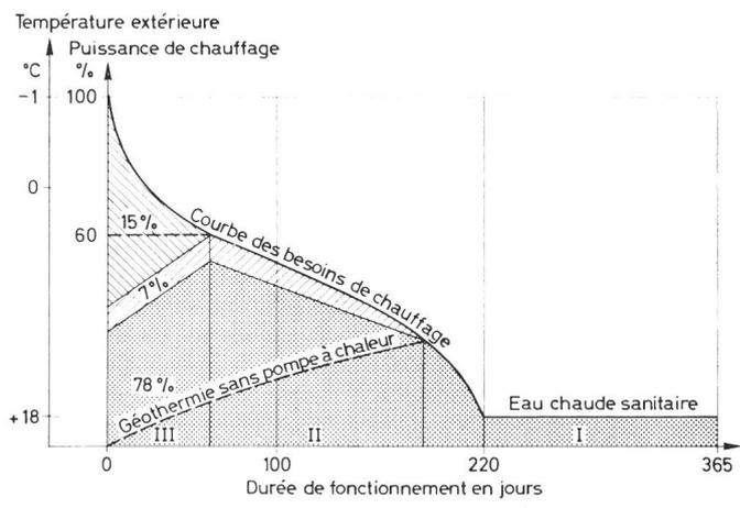
Fig. 3 Courbe de charge d'une installation de chauffage
