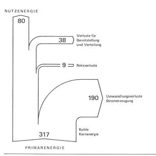
Fig. 4 Energieflussdiagramm der Warmwasserversorgung eines Einfamilienhauses
