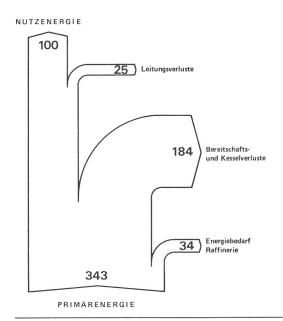
Fig. 3 Energieflussdiagramm der Warmwasserversorgung eines Einfamilienhauses
