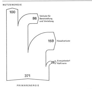
Fig. 1 Energieflussdiagramm der Warmwasserversorgung eines Mehrfamilienhauses mit 6 Wohnungen Zentralversorgung durch Ölheizkessel (mit Zirkulation)
