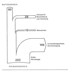
Fig. 2 Energieflussdiagramm der Warmwasserversorgung eines Mehrfamilienhauses mit 6 Wohnungen
