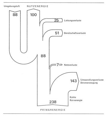
Fig. 5 Energieflussdiagramm der Warmwasserversorgung eines Einfamilienhauses
