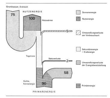
Fig. 6 Energieflussdiagramm einer Grundwasserwärmepumpe
