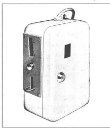
möglichkeit bis zu 9 Münzen mit Leuchtziffernanzeige der gespeicherten Münzen. Ein Spitzenprodukt ist der elektronische Münzzeitautomat für Solarienbetrieb, mit Münzprüfer, wobei nach Ablauf einer frei einstellbaren Zeit ein Summerton für 2 s ertönt und nach Ablauf der Totalzeit eine Sperrzeit von 5 min zur Abkühlung der Solarlampe beginnt. Erst nach Ablauf dieser Sperrzeit wird der Münzeinwurfschlitz wieder geöffnet, und das Gerät ist wieder betriebsbereit.
