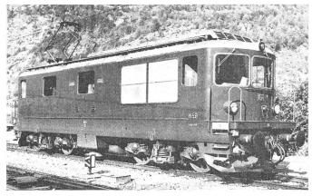
Fig. 13 Gleichrichterlokomotive Re 4/4 der BLS (1965)
