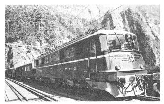
Fig. 9 Gotthardlokomotive Co'Co' Ae 6/6 der SBB (1953...1966)
