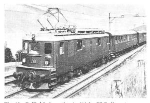
Fig. 12 Bo'Bo'-Lokomotive Ae 4/4 der BLS, die erste laufachslose Lokomotive hoher Leistung (1944)
