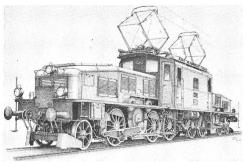
Fig. 7 Güterzuglokomotive (1'C) (C1'), Ce 6/8 für die Gotthardstrecke (1920)
