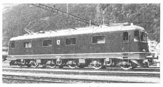
Fig. 11 Hochleistungslokomotive Bo'Bo'Bo' Re 6/6 der SBB (1975)
